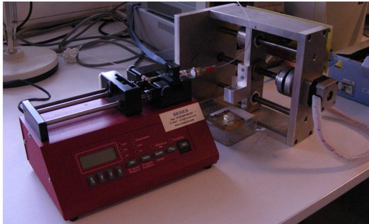
FIG. 3.9 – Banc de dépôt par capillarité.
