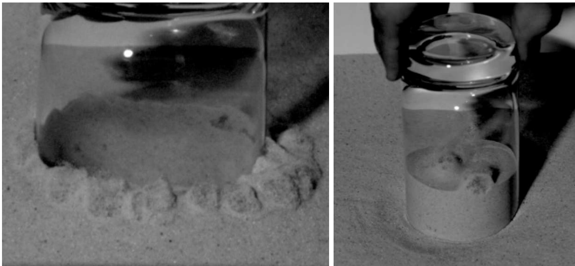
Fig. C.10 – A gauche : image prise à la caméra rapide lors de l'enfoncement brutal d'un verre de cuisine dans du sable. A droite : image prise lors de l'extraction lente d'un verre de cuisine préalablement enfoncé dans le sable.
