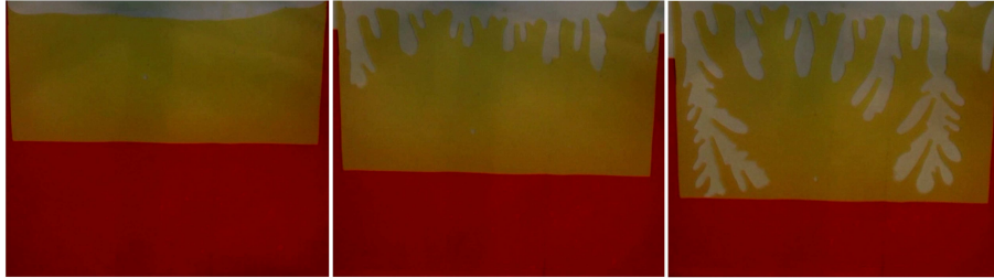
Fig. 6.2 – Images tirées d'une expérience avec une large bande d'huile initiale. Les doigts d'air sont proches les uns des autres, comparés à la distance au piston, et certains poussent plus vite que d'autres, limitant la croissance des voisins. Cet écrantage est typique de la digitation visqueuse classique.
