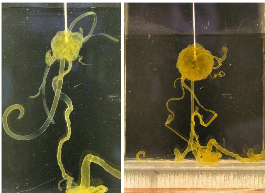
Fig. 2.9 – Morphologies de précipités après une vingtaine de secondes. c = 65\text{g/L} , Q_{inj} = 8\text{mL/min} . On voit bien au bout de l'aiguille d'injection la zone de blobs globalement sphérique de laquelle partent les tubes.
