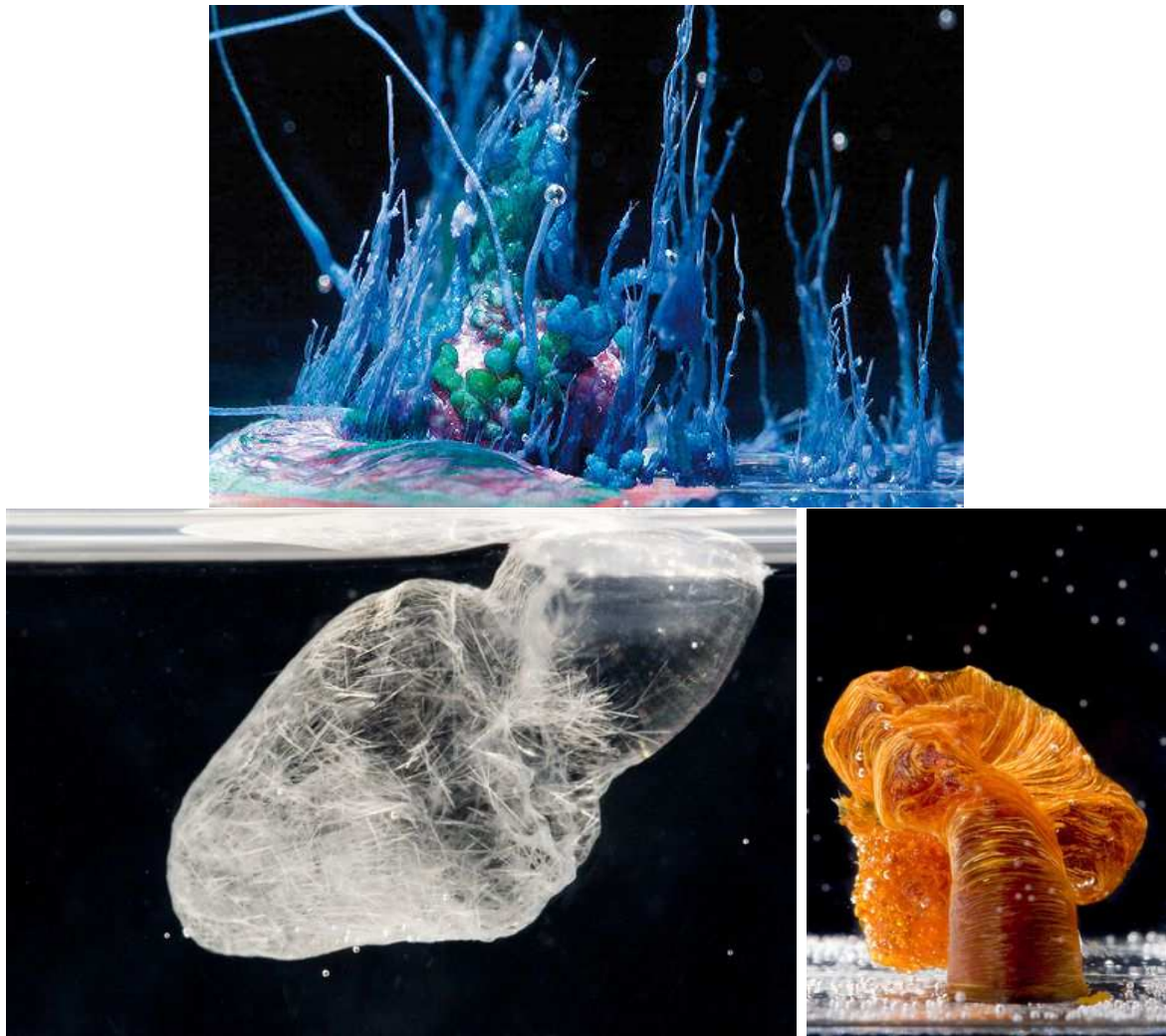
Fig. 2.5 – Jardins chimiques dans une solution de silicate de sodium. En bleu : croissance de sulfate de cuivre. En blanc : Croissance de chlorure de calcium. En orange : croissance de sulfate de fer III. Photos : S. Querbès ©
