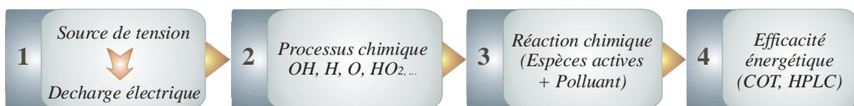
Figure I.1 - Traitement de l'eau par décharge électrique, étapes simplifiées
