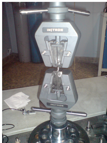
FIGURE 11.4 – Photographie du dispositif de traction sur plaque utilisé pour déterminer le coefficient de joint local des éprouvettes soudées en compression-torsion.
