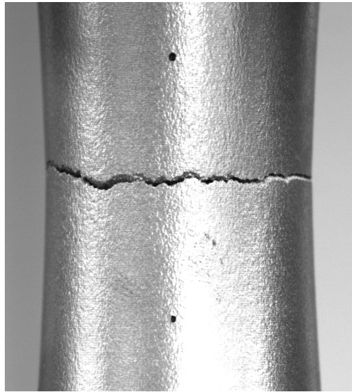
FIGURE 9.2 – Faciès de rupture en traction monotone d'une éprouvette non sectionnée. À noter, les deux cibles utilisées pour la mesure de la déformation locale.
