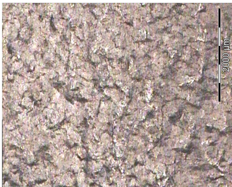
FIGURE 6.6 – Rugosités de surface apparaissant après déformation à l’interface d’un échantillon non soudé dont l’état de surface initial était poli miroir (1 \mu\text{m} ).
