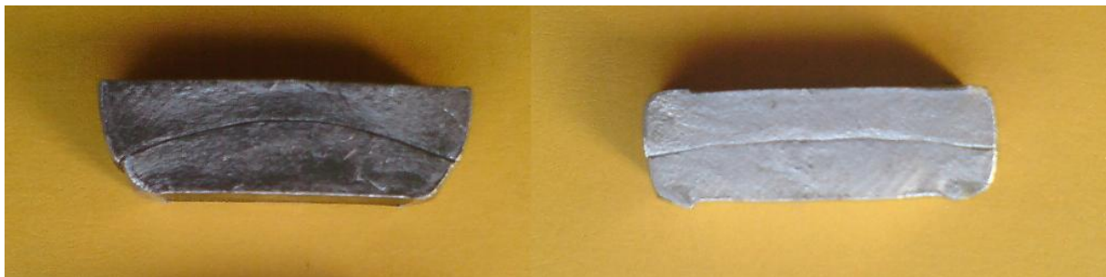
FIGURE 6.3 – Photographies de deux échantillons soudés en compression plane : à chaud (à gauche) et à froid (à droite). À noter, le meilleur contrôle du frottement à froid.
