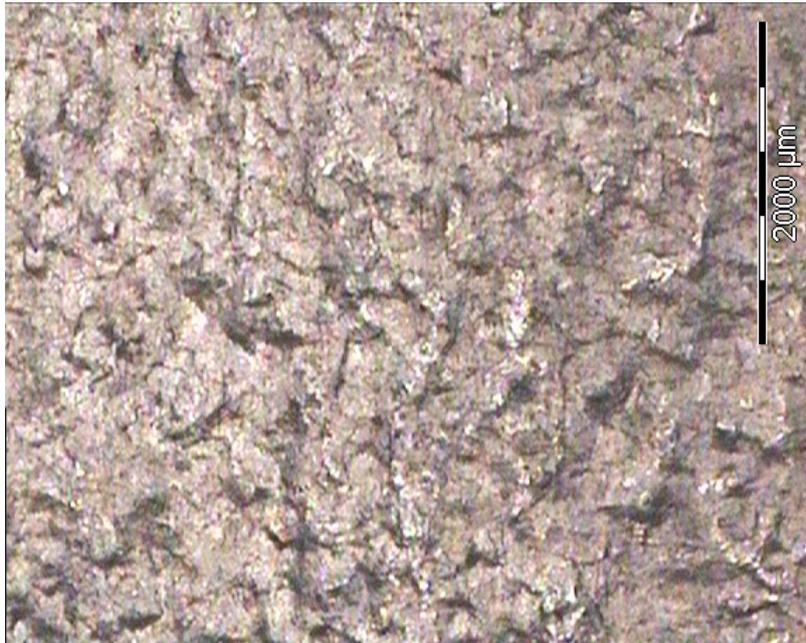
FIGURE 6.6 – Rugosités de surface apparaissant après déformation à l’interface d’un échantillon non soudé dont l’état de surface initial était poli miroir (1  $\mu\text{m}$ ).
