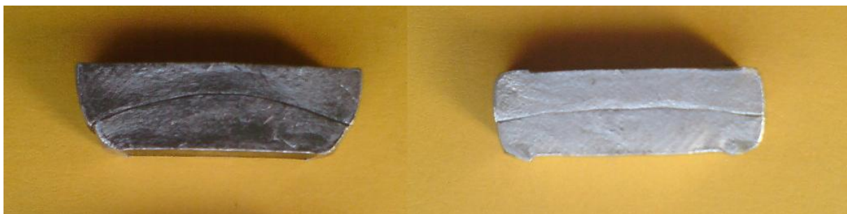
FIGURE 6.3 – Photographies de deux échantillons soudés en compression plane : à chaud (à gauche) et à froid (à droite). À noter, le meilleur contrôle du frottement à froid.
