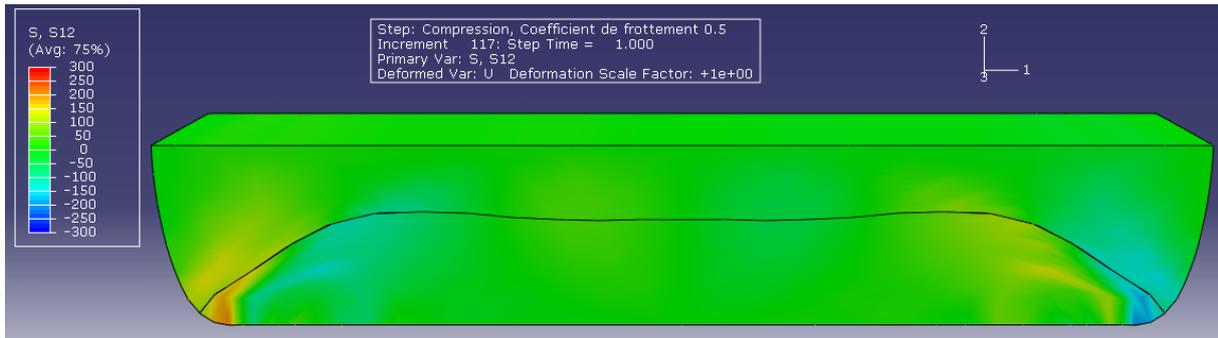
FIGURE 8.3 – Déformée et champ de contrainte de cisaillement  $\sigma_{12}$  pour un coefficient de frottement de Coulomb  $\mu = 0,5$ .
