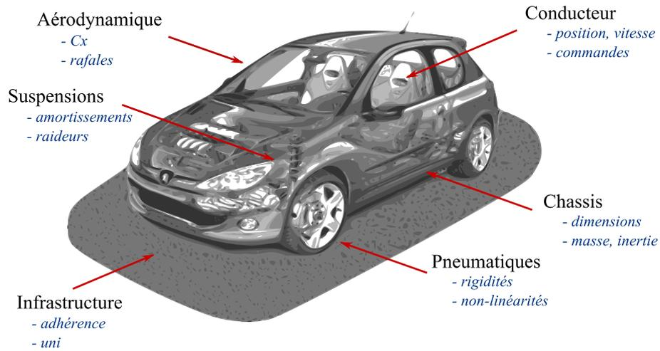
FIGURE III.1 – Familles de paramètres du modèle mécanique
