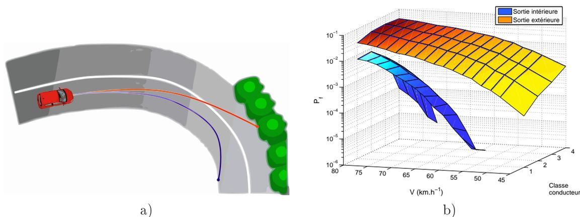
FIGURE IV.10 – Séparation des cas de sortie intérieure et extérieure
