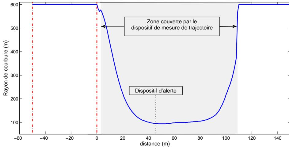
FIGURE V.13 – Profil du virage Rd8, et emplacements des dispositifs de mesure
