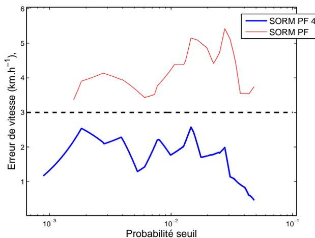
FIGURE IV.14 – Erreur commise sur la vitesse d’alerte en fonction de la probabilité seuil, pour la classe 2
