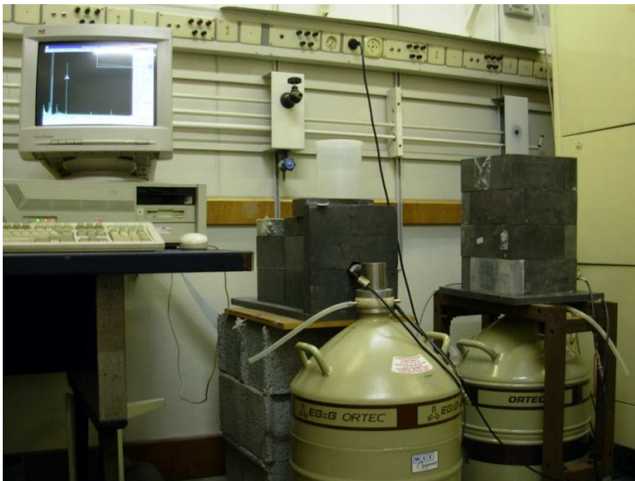
Figure 3. 10 : Spectromètres gamma (Ortec) utilisés au laboratoire LRSAE
