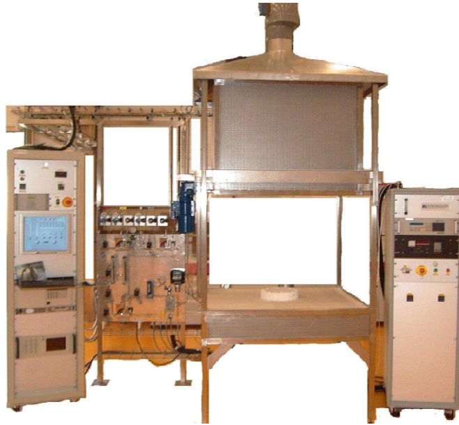
Figure 2. 13. Photographie du banc de test pour cellule SOFC
