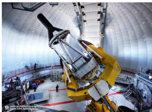
Fig. 3.1 – Le dôme du CFHT au sommet du Mauna Kea et l'instrument MegaPrime qu'il abrite. La caméra MegaCam est installée dans la nacelle noire, à 15 m de hauteur. Crédits : CFHT.
