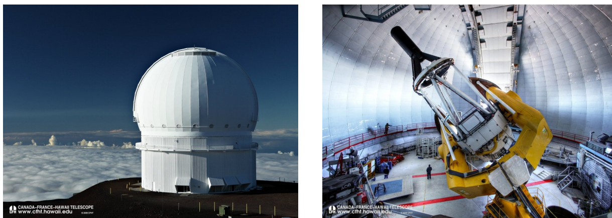
Fig. 3.1 – Le dôme du CFHT au sommet du Mauna Kea et l'instrument MegaPrime qu'il abrite. La caméra MegaCam est installée dans la nacelle noire, à 15 m de hauteur. Crédits : CFHT.
