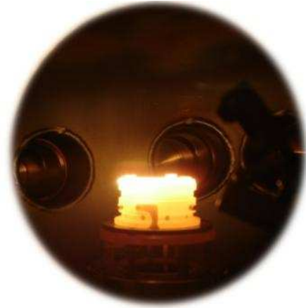
Figure 23 : Aspect du porte-échantillon (composé de Mo et W) du four à bombardement électronique pendant un recuit à 2073 K sous vide.
