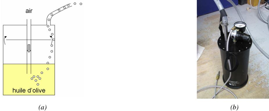
Figure A-6 : Pulvérisateur de type Laskin-Nozzle (a) et système utilisé lors des essais en soufflerie (b).
