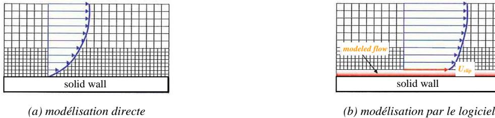
Figure IV-18 : Modélisation de la couche limite sur une paroi solide de manière directe (a) et par le code de calcul (b) [POW-06].
