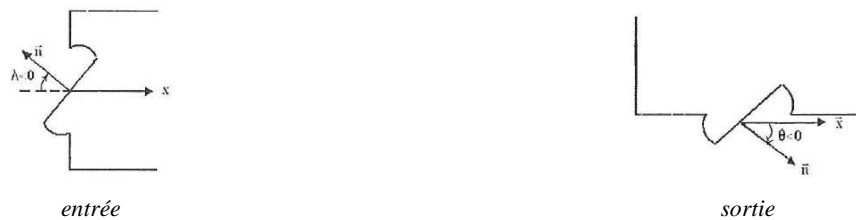
Figure II-41 : Configurations géométriques dans les sections d'entrée et de sortie du compartiment moteur lorsque les vitesses sont considérées normales aux sections d'entrée et de sortie [IVA-05].
