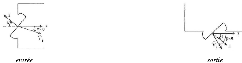
Figure II-42 : Configurations géométriques dans les sections d'entrée et de sortie du compartiment moteur lorsque les angles \alpha et \beta sont introduits pour caractériser la direction des vecteurs vitesse [IVA-05].
