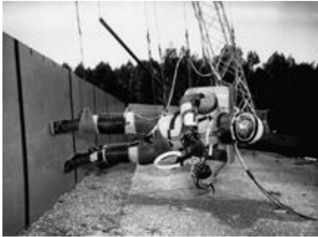
Figure 2. Simulateur de gravité lunaire, Centre de Recherche Langley de NASA, Virginia, Etats-Unis. Le sujet habillé en costume spécial est supporté par des fils de façon qu'un-sixième de son poids soit appliqué sur un mur incliné dans le but de simuler la marche sur la surface lunaire
