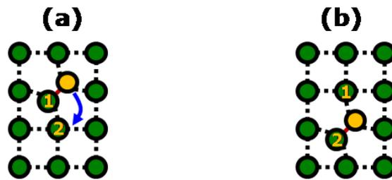
**FIGURE I.11** – Illustration du mécanisme de diffusion interstitiel (D.I). La paire dopant-interstitiel occupe un site substitutionnel. La diffusion du défaut se fait en déformant l’arrangement du cristal.
