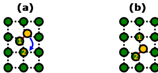
FIGURE I.11 – Illustration du mécanisme de diffusion interstitiel (D.I). La paire dopant-interstitiel occupe un site substitutionnel. La diffusion du défaut se fait en déformant l’arrangement du cristal.
