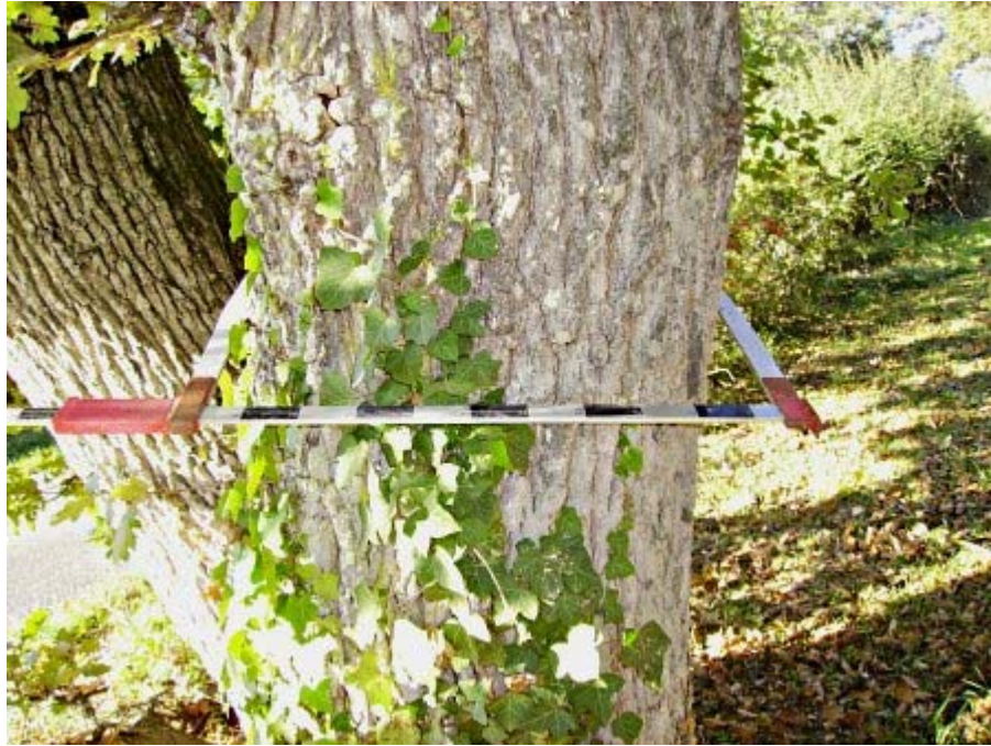
Figure N° 8 : Mesure de diamètre à 1m30 à l'aide d'un compas forestier.
