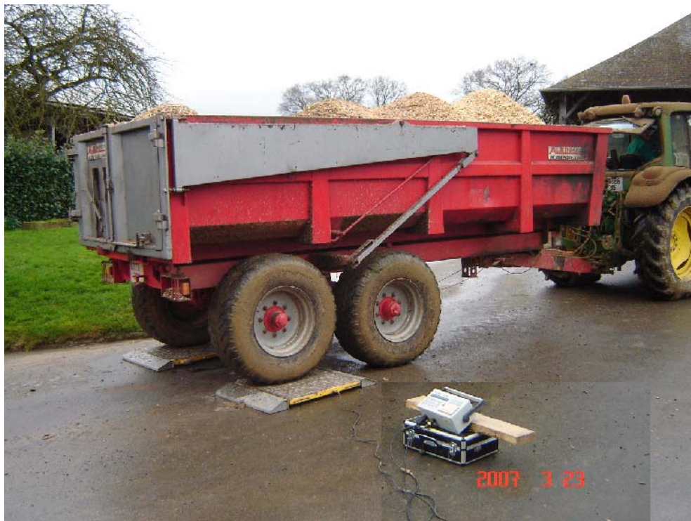
Figure N° 9 : Pesage de la production du bois par le peson mobile.
