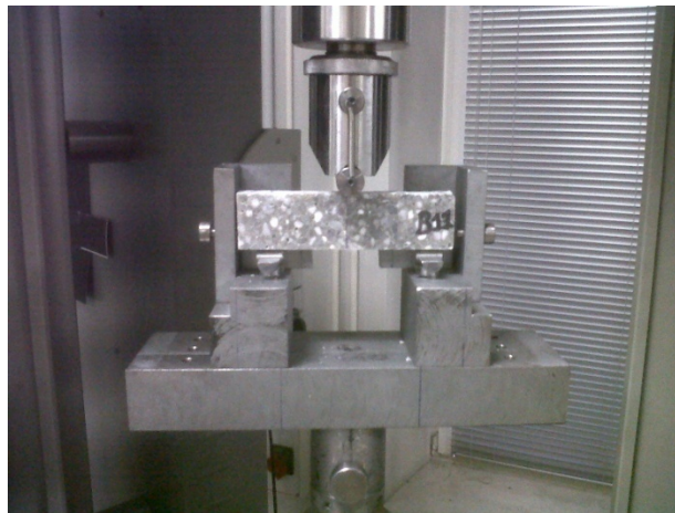
Figure 3-5 : Montage de flexion 3-points utilisé au LPMM.
