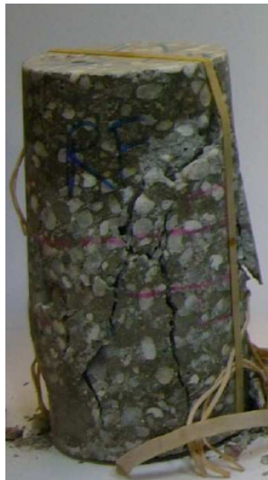
Figure 2-1 : Faciès de rupture d'une éprouvette de R30A7 après un essai de compression simple [Vu, 2007]
