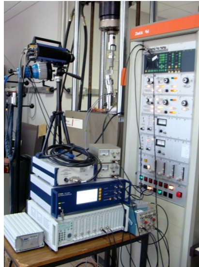
Figure 4-1 : Machine hydraulique rapide du LPMM lors d'un essai de traction directe dynamique
