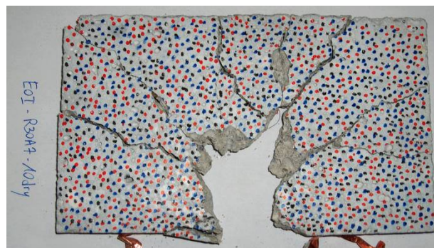
Figure 5-19 : Champ de déplacement U2 (en pixel, 1 pixel = 0,65 mm) (a) à t = 22 \mu\text{s} et (b) à t = 62 \mu\text{s} – essai sur R30A7 sec n°10, (c) carreau post mortem
