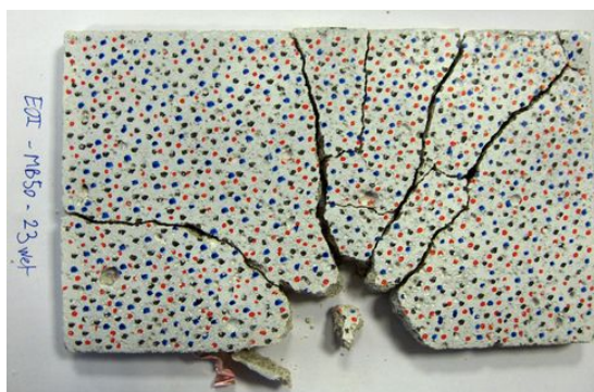
(a) (b) Figure 5-9 : Carreau post mortem des essais sur MB50 humide (a) n°23 et (b) n°26
