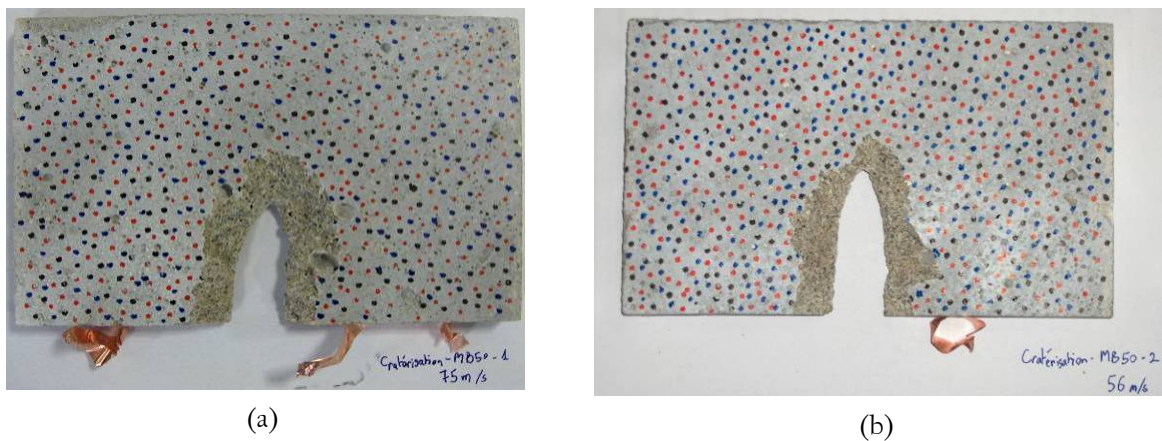
Figure 5-33: Faciès post mortem (a) de l'essai sur MB50 humide n°25 ( V_{\text{impact}} = 75 \text{ m/s} ) et (b) de l'essai n°24 ( V_{\text{impact}} = 56 \text{ m/s} )
