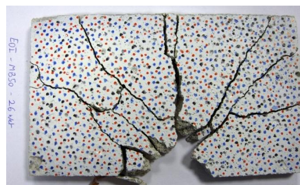
(a) (b) Figure 5-9 : Carreau post mortem des essais sur MB50 humide (a) n°23 et (b) n°26
