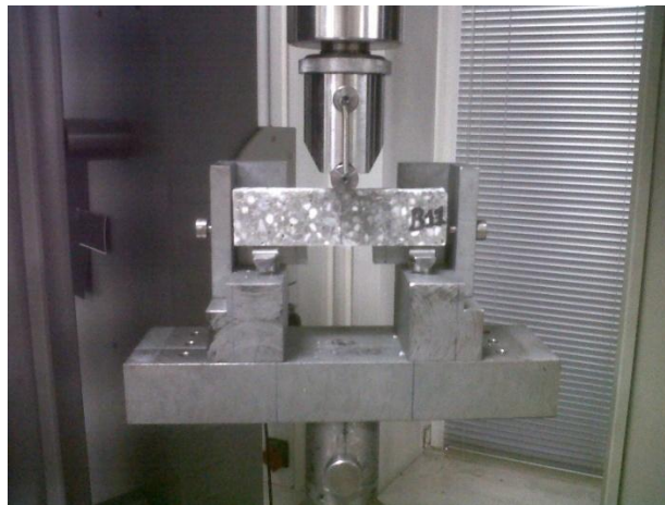
Figure 3-5: Montage de flexion 3-points utilisé au LPMM.
