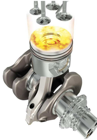
FIGURE 4: Explosion à l'intérieur de la chambre de combustion
