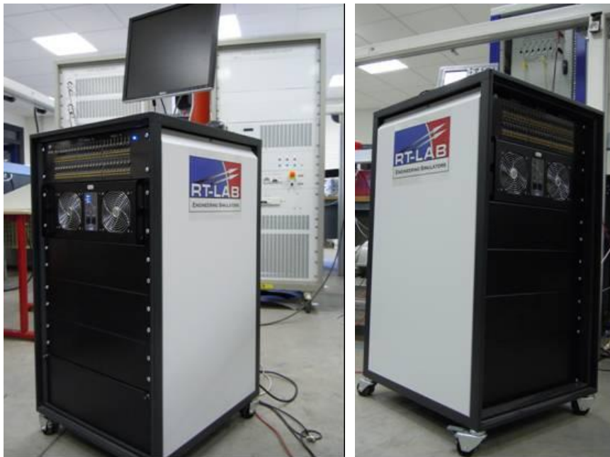
Figure 3-30 : Stations de calcul de RT-LAB ® : Maître (à droite) / Esclave (à gauche)
