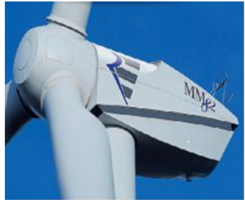
Figure 1-3 : Nacelle d'une éolienne MM82 (vue de l'extérieur)
