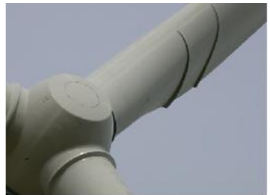
Figure 1-4 : Pale et multiplicateur d'une éolienne MM82
