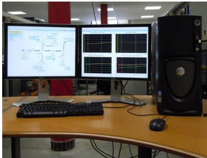
Figure 3-31 : Interface développée par PcVue pour le réglage D2-RCT
