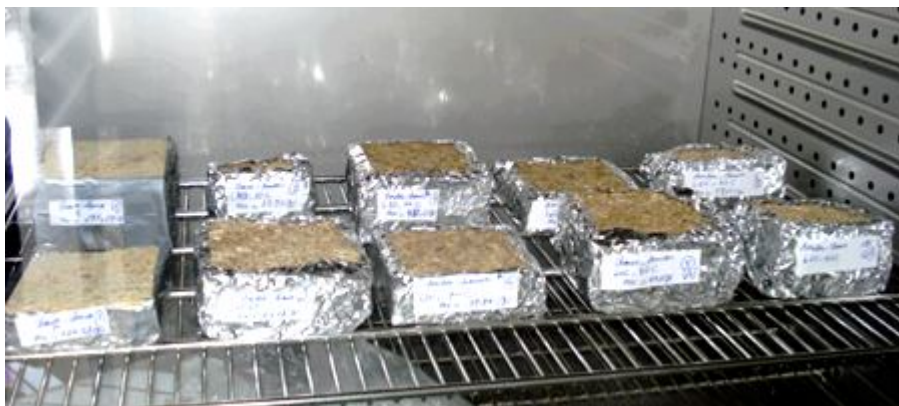
Figure A. 51: Exposition et emplacement des échantillons dans l'enceinte climatique.
