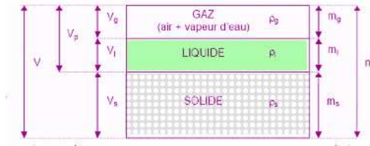
Figure 1. 8 : Les trois phases d'un milieu poreux non saturé.
