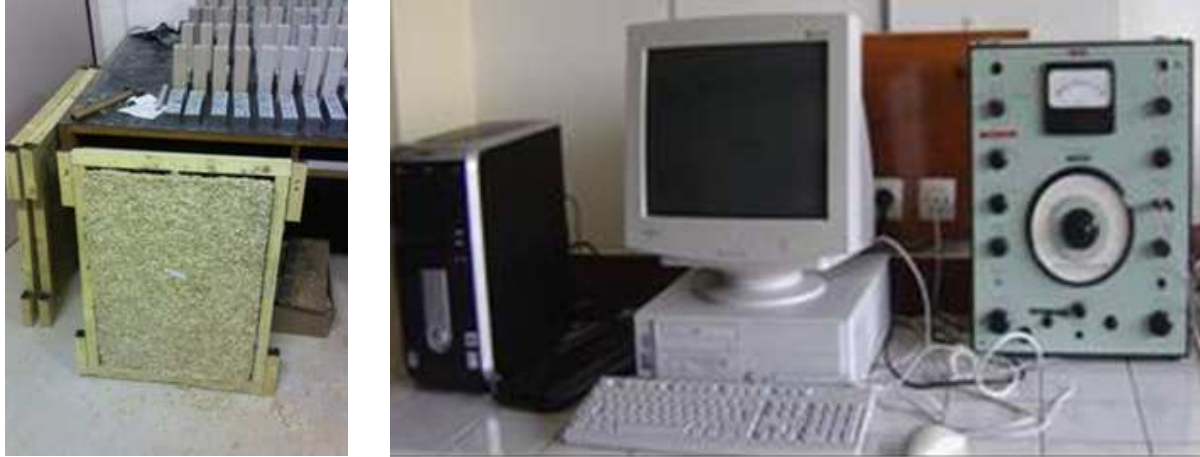
Figure 4. 3 : Panneau en béton de chanvre (0,5*0,68*3,5cm) (à gauche) avec l'appareil de mesure (à droite).
