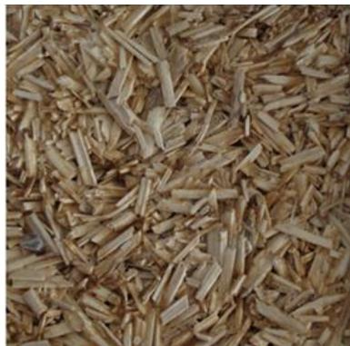
*Figure a : Surface de l'échantillon 4B Chanvre-amidon (30L/70C).*
