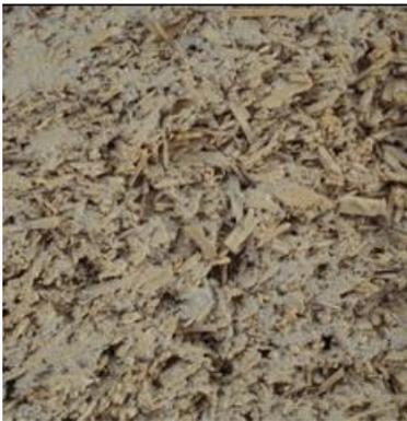
Figure a : Surface de l'échantillon 1A Chanvre-chaux
