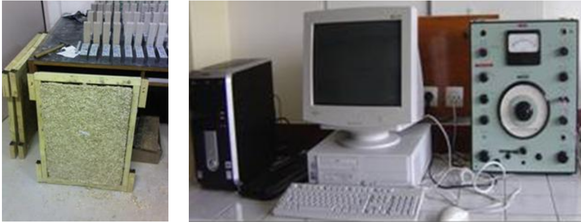
Figure 4. 3 : Panneau en béton de chanvre ( 0,5*0,68*3,5\text{cm} ) (à gauche) avec l'appareil de mesure (à droite).
