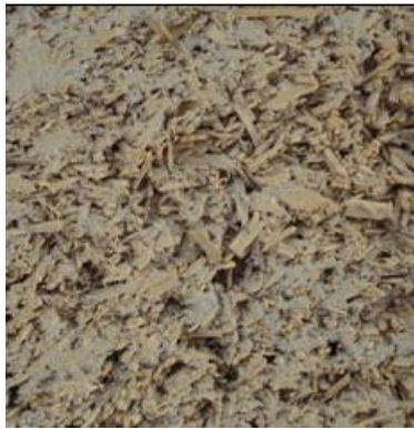
Figure a : Surface de l'échantillon 1A Chanvre-chaux
