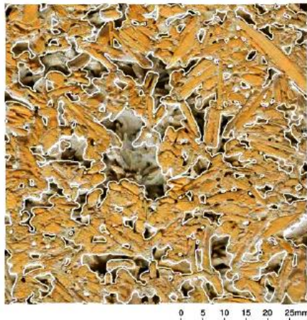
Figure 12.a : Porosité du béton de chanvre.
