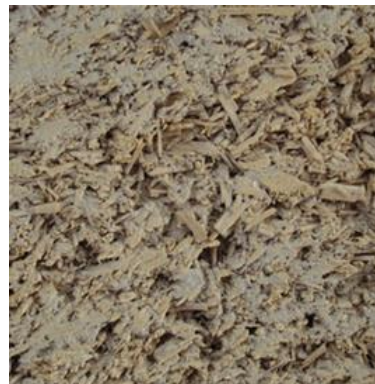
Figure b: Surface de l'échantillon 1A Chanvre-chaux.
