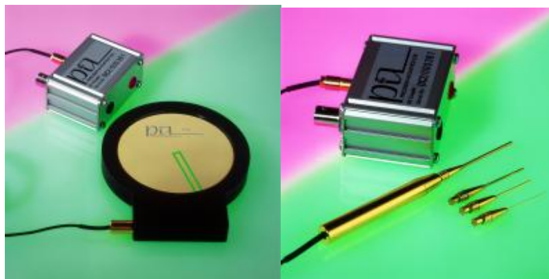
Figure 5. Hydrophone membrane (à gauche) et hydrophone aiguille (à droite) (photo Precision Acoustic)
