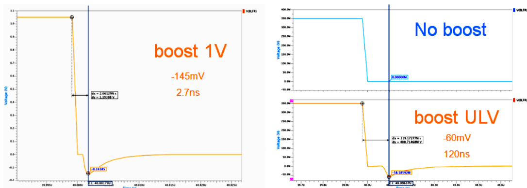
Figure 4.30 – Simulation du chemin critique à tension nominale (gauche) et à très faible tension (droite) avec la solution d’assistance à l’écriture.
