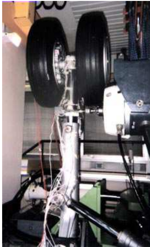
FIG. 6.5 – Montage expérimental pour l'excitation en torsion autour de Z.
