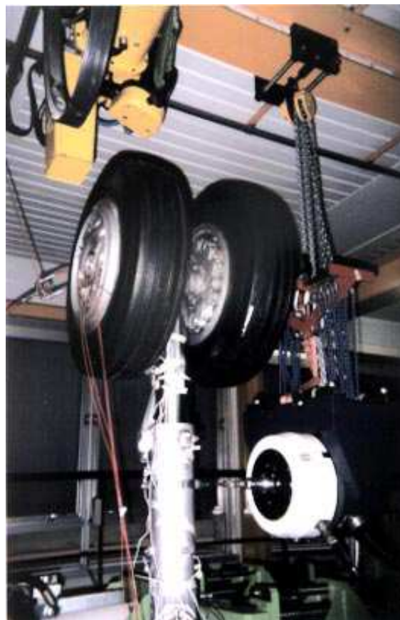
FIG. 6.4 – Montage expérimental pour l'excitation de direction Y.
