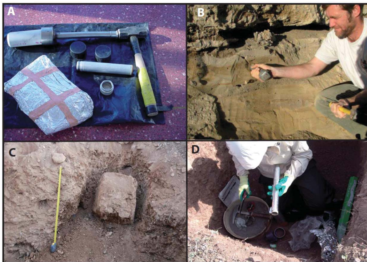
Figure II-13 : Matériel et méthodes d'échantillonnage OSL. A) Matériel nécessaire à la collecte des échantillons. B) Exemple de collecte par percussion d'un tube métallique dans des sables fluviaux. C) Exemple d'un bloc collecté au niveau d'une terrasse alluviale. D) Matériel utilisé lors d'une collecte par extraction manuelle sous bâche (CEMB), dans un cône alluvial.
