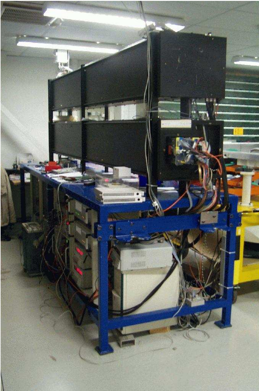
FIG. 3.7 – Photographie du banc de test utilisé au LPC pour la certification des super-tiroirs lors de leur production. Le système permettait de tester deux super-tiroirs simultanément. Le patch-panel d'un super-tiroir est visible dans le logement du bas.
