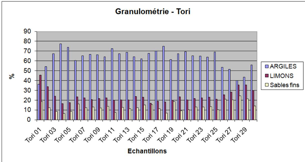
FIGURE 35 : GRANULOMÉTRIE DES ÉCHANTILLONS – DONNÉES DE TERRAIN
