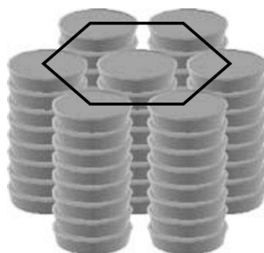
Figure 7 : Représentation schématique d'une phase cristal-liquide colonnaire hexagonale.
