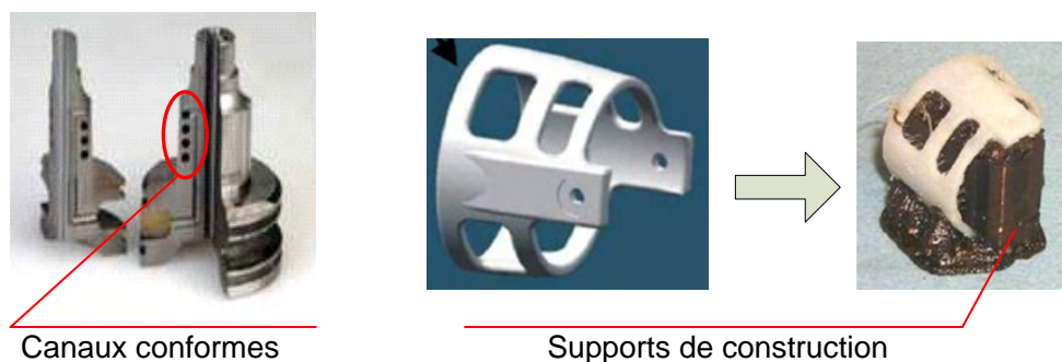
Figure 69 : Exemple d'entités spécifiques aux procédés par ajout de matière
