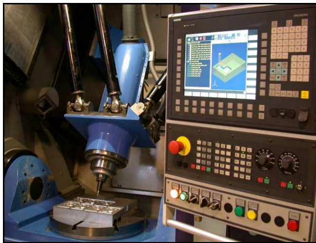
Figure 65 : Plate-forme SPAIM intégrée sur une CN industrielle Siemens 840D
