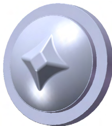
Figure 105 : Modèle de la matrice d'emboutissage étudiée
