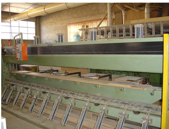
Postformeuse à chaud
