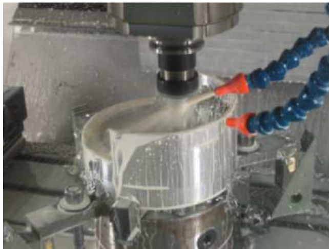
FIG. 3.15 – Fabrication de l'écran froid du banc infra-rouge avec la fraiseuse à commande numérique du LPNHE.
