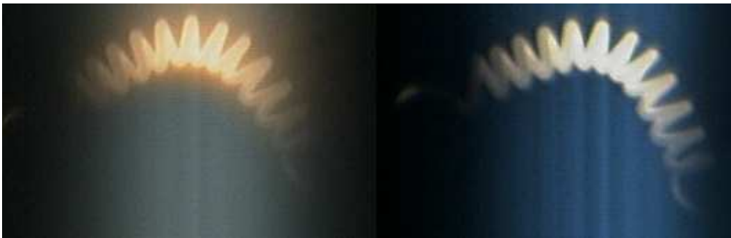
FIG. 5.18 – Image du filament de l’ampoule lorsqu’elle est parcourue par deux courants distincts (le temps de pose n’est pas le même).
