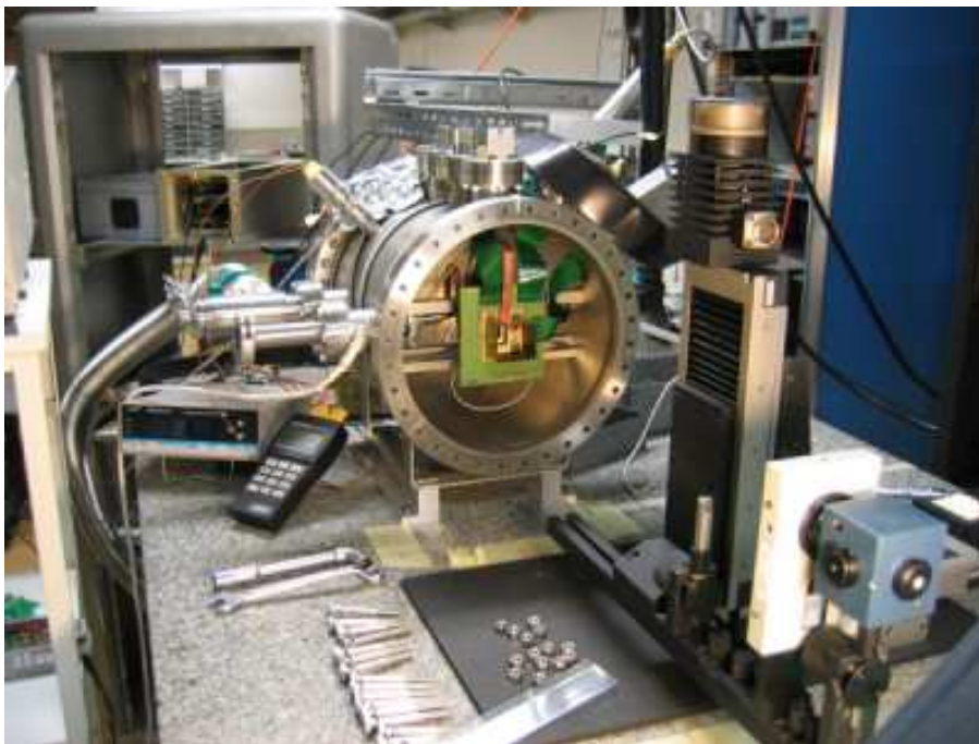
FIG. 3.1 – Vue d’ensemble du banc de test CCD lors de modifications : cryostat ouvert, plan focal, optique (table XY, sphère intégrante, obturateur).
