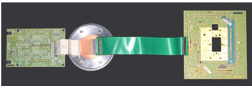
FIG. 3.6 – Reconstitution des connexions électroniques pour le suivi cryogénique : de droite à gauche : carte électronique du plan focal, nappe de câbles ('flex'), connecteur vissé sur le port de sortie du cryostat ('feedthrough'), carte électronique placée dans le boîtier monté sur le port de sortie.
