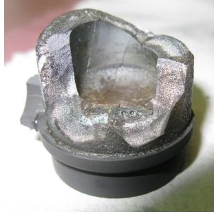
Figure 5-24 : Support et creuset en \text{UO}_2 après l'essai de fusion de la charge \text{UO}_2 - \text{Al}_2\text{O}_3 - \text{Eu}_2\text{O}_3 . La température maximale de l'essai était de 1900^\circ\text{C} . Sans le revêtement intermédiaire en \text{ZrC} le creuset a été collé au support.
