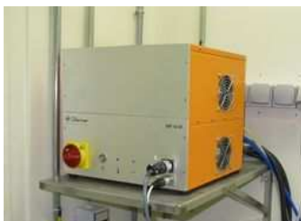
Figure 5-3: Générateur VITI - 24 kWatt - Fréquence : 23 kHz
