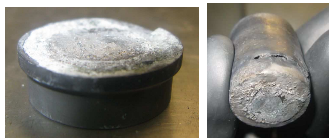
Figure 5-23 : Support et creuset en \text{UO}_2 après l'essai de fusion de la charge \text{UO}_2 - \text{Eu}_2\text{O}_3 . La température maximale de l'essai était de 2200^\circ\text{C} . Un revêtement intermédiaire en \text{ZrC} a été formé à l'interface, empêchant ainsi l'interaction entre les deux éléments.
