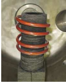
Figure 5-5: Inducteur VITI et la cloche thermique
