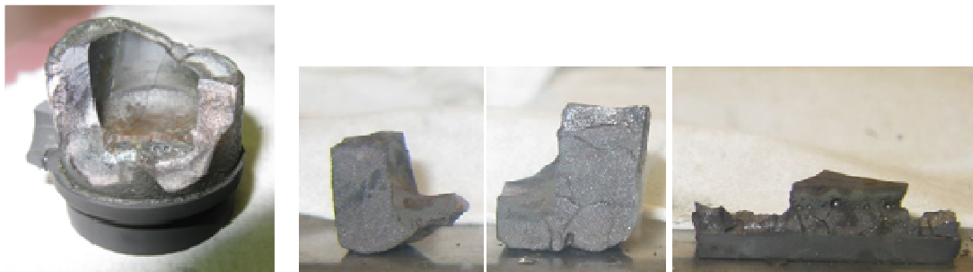
Figure 6-42 : Le mélange 30% UO_2 – 33% Al_2O_3 – 37% Eu_2O_3 en proportions massiques après le chauffage jusqu'à 1870^\circ C et le refroidissement dans un creuset en UO_2 . Le diamètre externe du creuset est de 27 mm.
