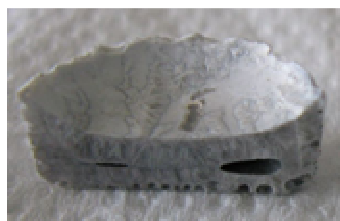
Figure 6-39 : Le mélange 50% HfO_2 + 50% Al_2O_3 en proportions massiques après le chauffage jusqu'à 2120^\circ C et le refroidissement dans un creuset en tungstène. Le diamètre externe de la charge est de 20 mm.
