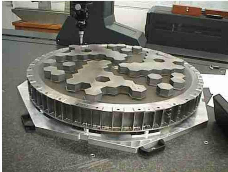
FIGURE 4.5 – Le masque codé en Tungstène utilisé sur SPI
