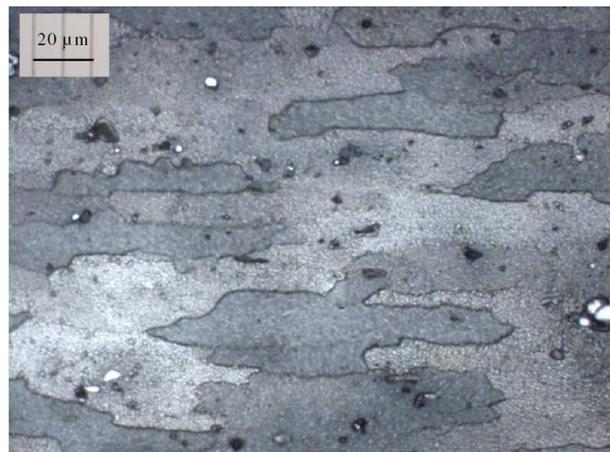
**Figure 2.14** – Grains observés au microscope optique pour un grossissement de 500 sur la face 1
