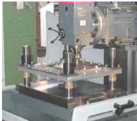
**Figure 1.23** – Machine CNC équipée d'un serre-flan mobile [DUF 05]
