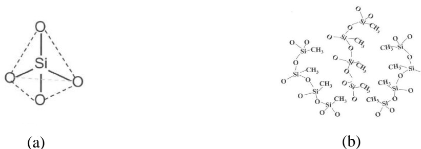
Figure II-4 : (a) Structure cristalline du \text{SiO}_2 . (b) Structure du SiOCH : le volume stérique des groupes carbonés -\text{CH}_n permet une diminution de la densité [Maex03].
