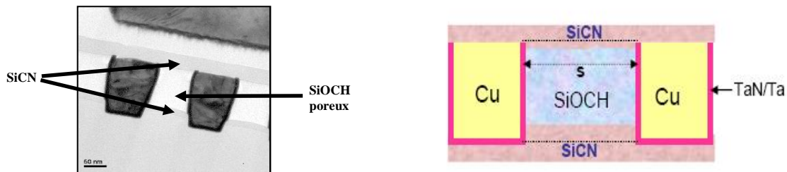
Figure V-3 : Coupe TEM d'une structure de test étudiée et schématisation.
