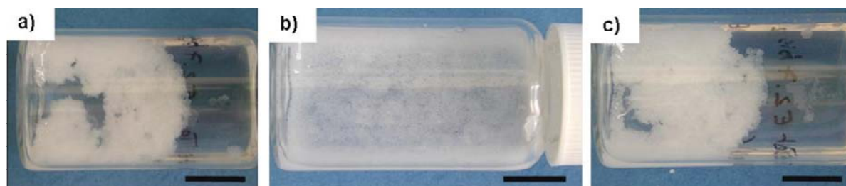
Figure 2.27. Etat de dispersion de l'émulsion a) après agitation manuelle vigoureuse, b) après une agitation douce et c) après une nouvelle agitation vigoureuse. La barre d'échelle représente 1cm.
