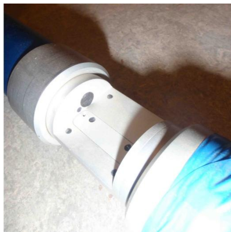
Figure 49: Fenêtre de mesure du spectrophotomètre S::CAN
