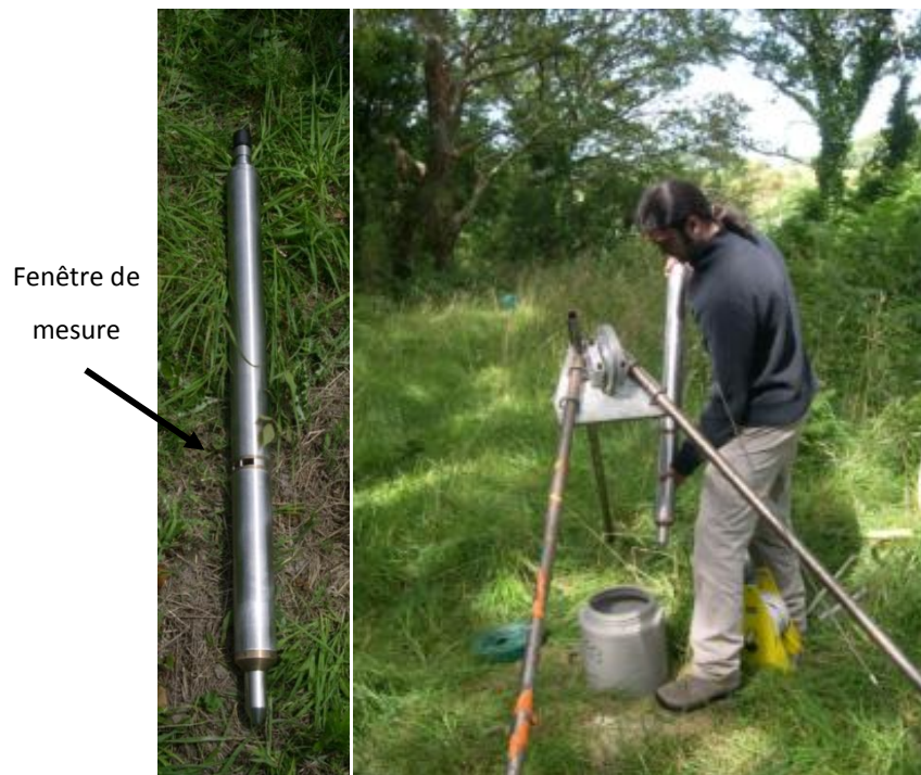
Figure 46: Sonde nitrate Geovita. a) Sonde, b) mise en place de la sonde
