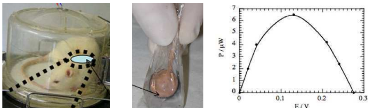
Figure 4. Implantation d'une biopile glucose/O 2 dans un rat de l'espèce Rattus norvegicus . De gauche à droite : le rat, la biopile, et la courbe de puissance mesurée in vivo . La GOx et l'ubiquinone sont utilisées à l'anode ; la polyphénol oxydase et la quinone à la cathode.
