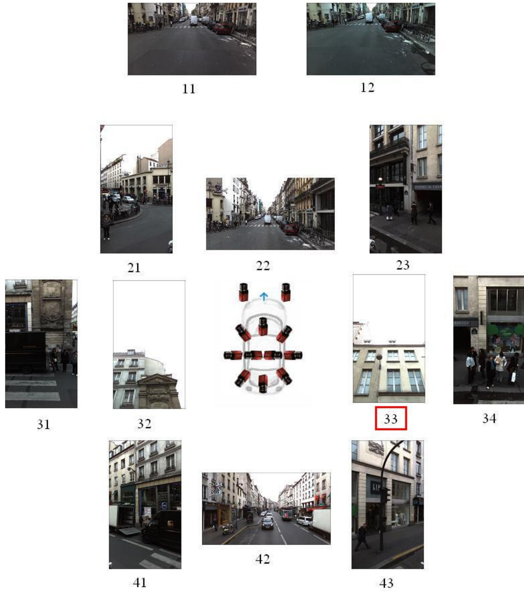
FIGURE 2.9 – Clichés pris à un instant t par le camion Stéréopolis. Dans notre cas, seules les photos de la caméra 33 nous intéressent.
