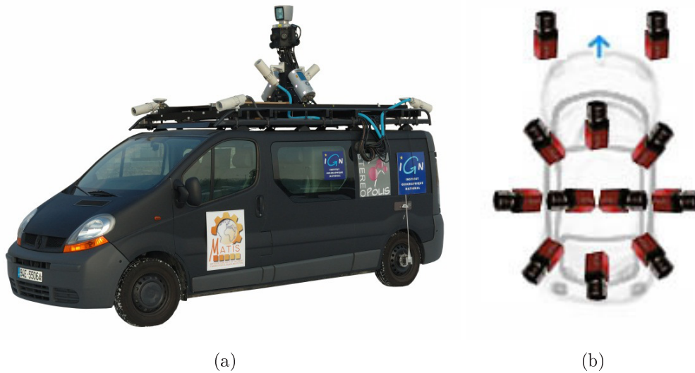
FIGURE 1.2 – Le véhicule Stereopolis et ses caméras.
