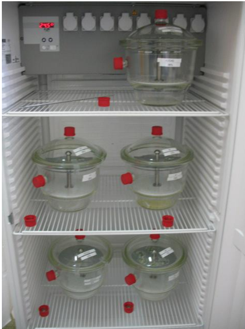
Figure 87: Disposition des dessiccateurs dans l'enceinte thermoréfrigérée
